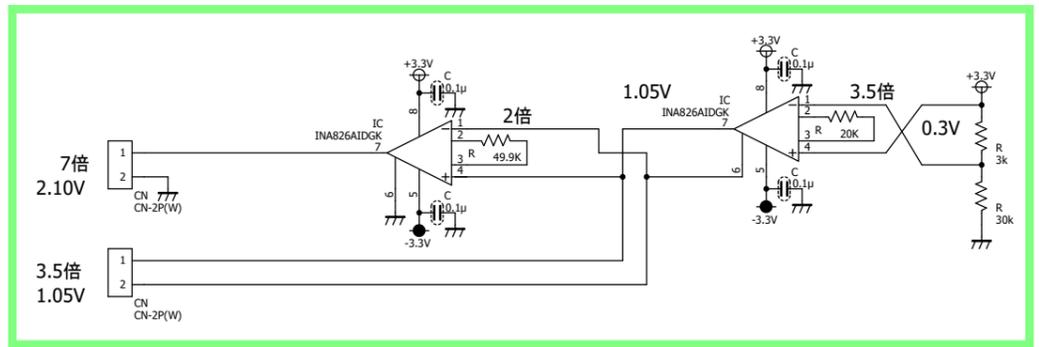
1段目のAMP入力は+電源電圧と+入力電圧が一緒です。
