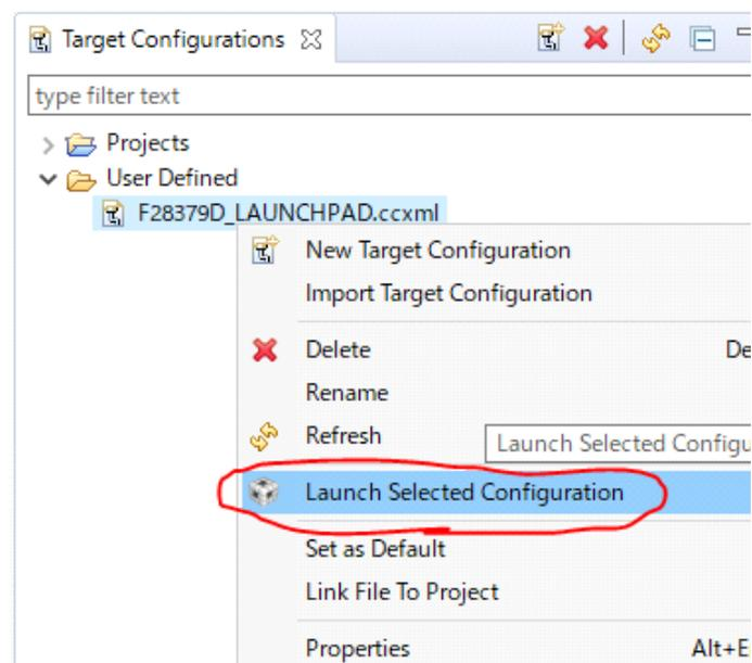
デバッグパースペクティブに切り替わりますので、接続するCPUを選択し、右クリックから
