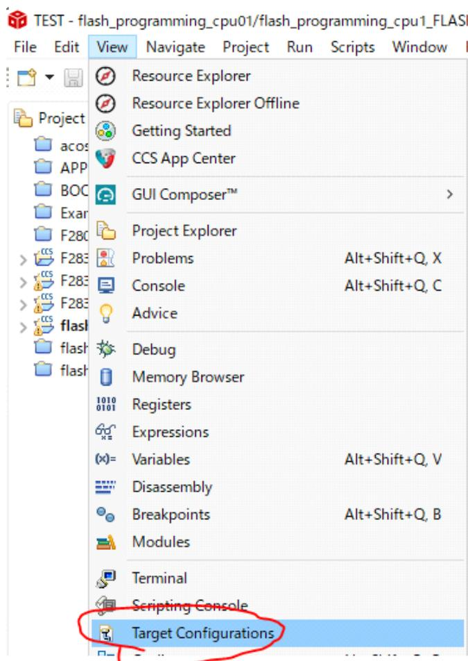
Target Configurationsウィンドウから、デバイスに接続するためのccxmlファイルを選択し、右クリックから"Launch Selected Configuration"を選択します。
